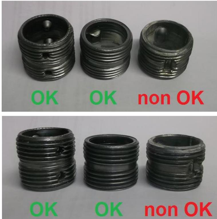
Attenzione: non utilizzare prodotti per la tenuta idraulica quali canapa, mastice o simili perché compromettono la tenuta del sistema di Elite Loft costituito dai nipples + o-ring originali. Elite Loft declina ogni responsabilità per perdite o altri inconvenienti causati dall'uso di questi materiali ed il loro impegno fa decadere la garanzia sul prodotto.
